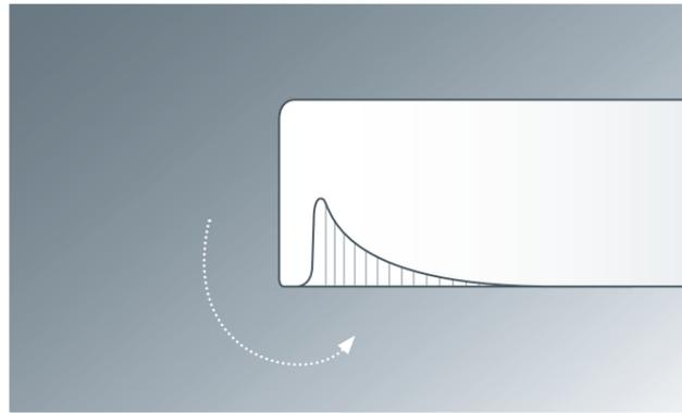
**Keramisches Sieb.** Als besonders hygienisch, weil leicht zu reinigen, erweist sich der Architec Waschtisch mit keramischem Sieb. Statt eines normalen Ablaufs, wo sich Schmutz und Bakterien sammeln können, läuft das Wasser einfach durch kleine Öffnungen in der Keramik ab.
