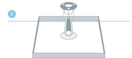
Position der Dusche mittels Einbaurahmen festlegen und die Ablaufposition anhand der mitgelieferten Schablone einzeichnen. Bei Höhengenaufbau ab 85 mm DuravitRapid (Unterbauelement) montieren oder Estrichsockel herstellen.
