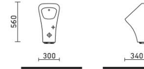
Elektronik-Urinal DuraStyle für Batterieanschluss
