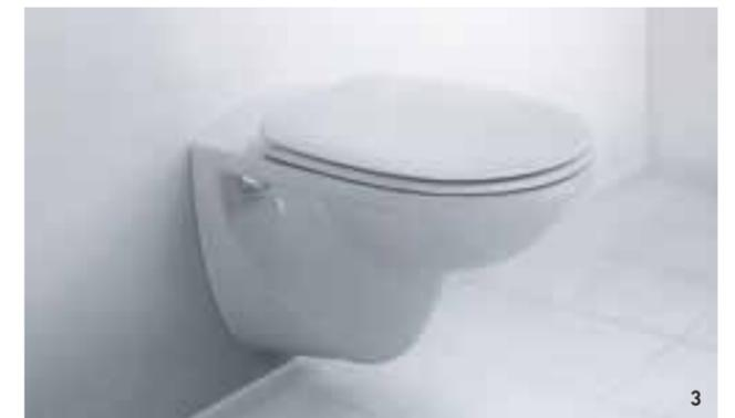
**D-Code barrierefrei.** Ideal für das barrierefreie Bad nach DIN 18040 ist das WC der Serie D-Code. Mit einer Sitzhöhe von 450–500 mm und einer Ausladung von 700 mm ist eine möglichst selbstständige Benutzung gewährleistet. Als Umsetzhilfen empfehlen sich fest verankerte, hochklappbare Stützgriffe.
