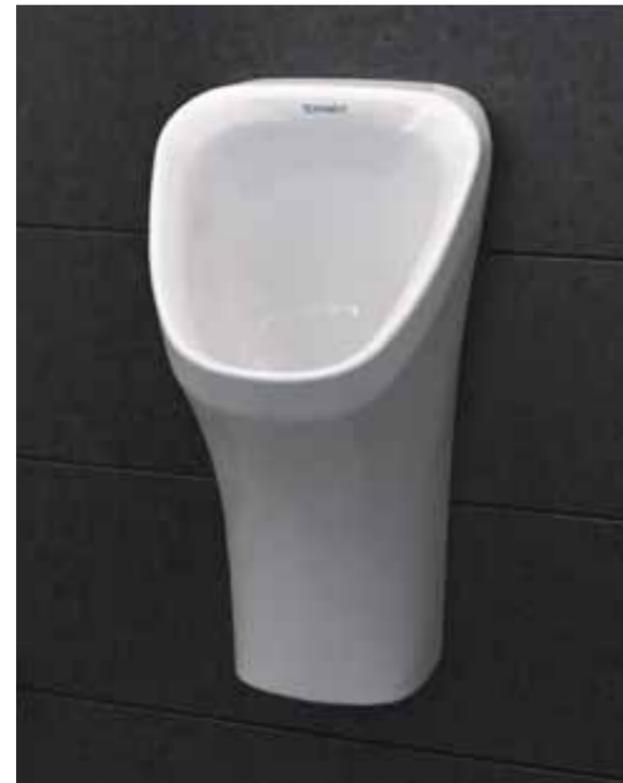
**Dry.** Trocken-Urinal ganz ohne Wasser. Die im Ablauf integrierte Schlauchmembran öffnet sich nur beim Durchfluss des Urins und verschließt sich danach wieder – automatisch und geruchsdicht. Der Duftring mit biologisch abbaubarem Gel zeigt an, wann es Zeit ist, den Geruchsverschluss\* zu wechseln (nach ca. 7500 Benutzungen). Das Dry-Urinal ist durch den Verzicht auf einen Spülrand ganz einfach zu reinigen.
