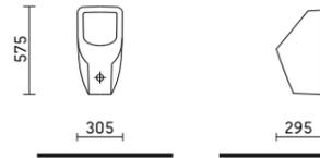
Urinal Duravit Rimless® D-Code mit Zulauf von hinten
