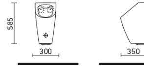
Elektr.-Urinal Duravit Rimless® 0,5l ME by Starck für Netzanschluss
