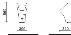
Elektronik-Urinal DuraStyle für Batterieanschluss
