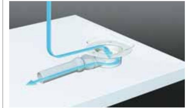
**Flexible Installation.** Mit Fußgestell (A, B) oder Wannenträger (C, D) können die DuraSolid® Duschwannen bodenbündig oder halbeingesetzt installiert werden. Selbsttragend, d. h. ohne Wannenträger oder Fußgestell, sind alle drei Einbauvarianten möglich, auch aufgesetzt (E). Dabei herrscht extreme Flexibilität bei der Einbauhöhe: Die Skala reicht von minimal 50 mm bis maximal 150 mm.
