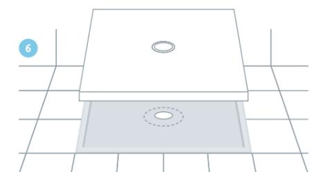
Fliesen verlegen und verfugen. Duschwannenrahmen einsetzen und ausrichten.
