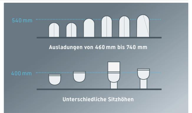
**Rimless: WCs und Urinale.** Bei der Rimless-Spültechnologie ermöglicht die offene Spülrandgestaltung eine dynamische, leistungsfähige Wasserführung: Die daraus resultierende kraftvolle Spülung garantiert selbst bei 4,5 l (WC) bzw. 0,5 l (Urinale) perfekte und hygienisch einwandfreie Spülergebnisse. Dank des offenen und gut zugänglichen Randbereichs lässt sich das Becken auch wesentlich leichter sauber halten.
