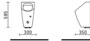
Elektr.-Urinal Duravit Rimless® 0,5l ME by Starck für Batterieanschluss
